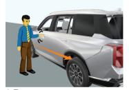
4. При закрывании двери автомобиля слегка прижмите ее, примерно за 10–20 см до упора, и убедитесь, что дверь автомобиля надежно закрыта. Убедитесь, что при закрывании двери не защемило одежду. Отходя от автомобиля, обходите его сзади.
