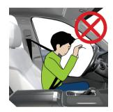
Во время управления автомобилем не наклоняйтесь слишком близко к рулю, в противном случае возможно получение травм при срабатывании системы SRS.
